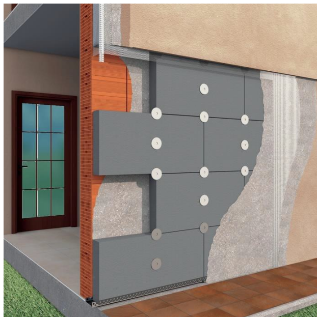
Figura 1 - Cappotto termico con Lana di roccia
